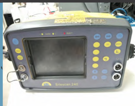
دستگاه UT مدل ۲۴۰ Sitiescan شرکت Sonatest
