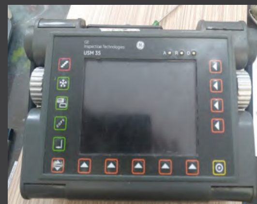
دستگاه UT مدل USM35 شرکت Krautkramer
