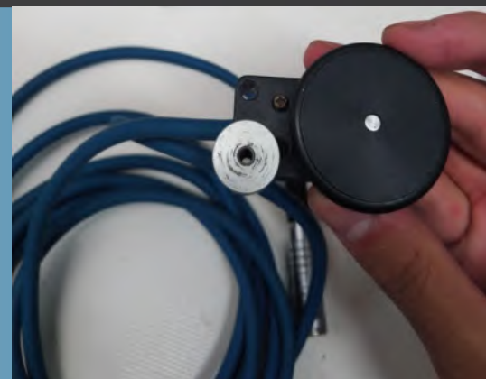
دستگاه انکودر C-clamp شرکت Phoenix
