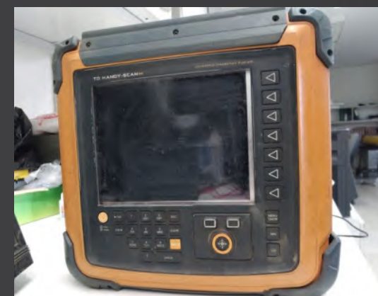
دستگاه PAUT مدل Handy scan شرکت TD
