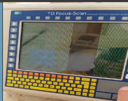
دستگاه PAUT مدل Focus scan شرکت TD
