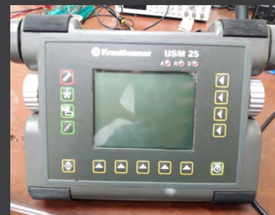
دستگاه UT مدل USM25 شرکت Krautkramer
